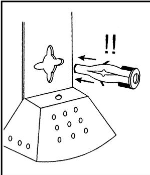
Der Dübel ist durch das Formloch der Grundplatte zu stecken.
